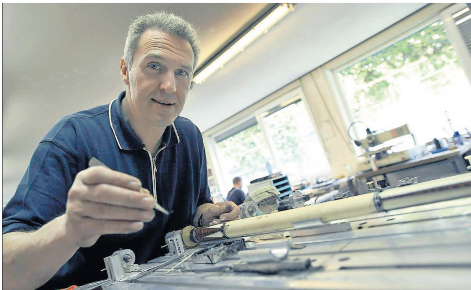
Feinarbeit: Marcus Dienst, Chef und Gründer der Frankenthaler Arthur Queue, fertigt ganz individuell gestaltete Billard-Spielstöcke mit Einlegearbeiten aus Gold, Silber, Edelsteinen und Edelhölzern. FOTO: BOLTE
